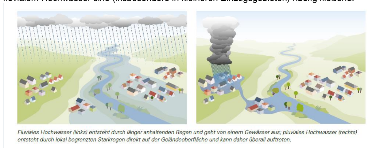
Abb. 3: Entstehung von fluvialem (links) und pluvialem (rechts) Hochwasser
