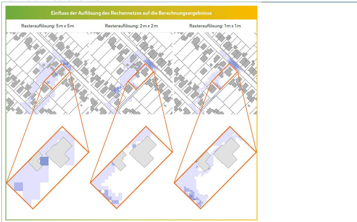
Abb. 22: Einfluss der Auflösung des Rechnetzes auf die Berechnungsergebnisse (HSB 2017)
